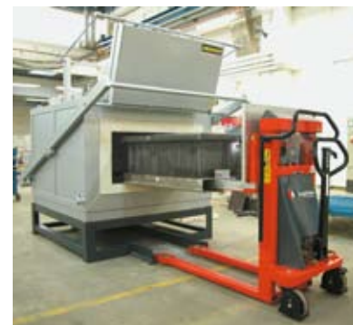
N 641 с закалочным ящиком и подъемной тележкой
