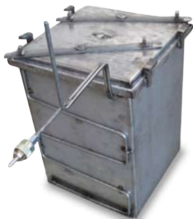
Ящик подачи газа с запирающей задвижкой
