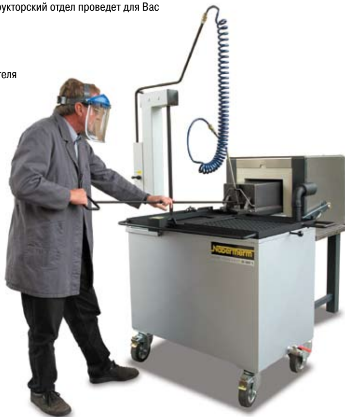
Система закаливания в защитном газе с печью N 41/H
