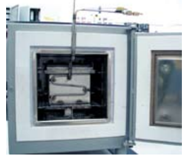
Печь с циркуляцией воздуха с ящиком подачи газа
